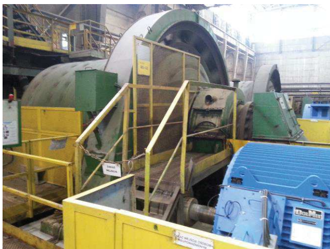
Napęd młyna kulowego, mielenia rudy miedzi P=640 kW, 187,5 obr/min
